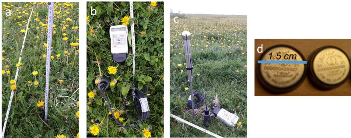
Figuur 3.27: Gebruikt materiaal voor het bepalen van de omgevingsfactoren: a) duimstok (vegetatiehoogte); b) ThetaProbe (bodemvochtigheid); c) penetrometer (bodemweerstand); d) ThermoChron i-buttons (bodem en lucht temperatuur).
