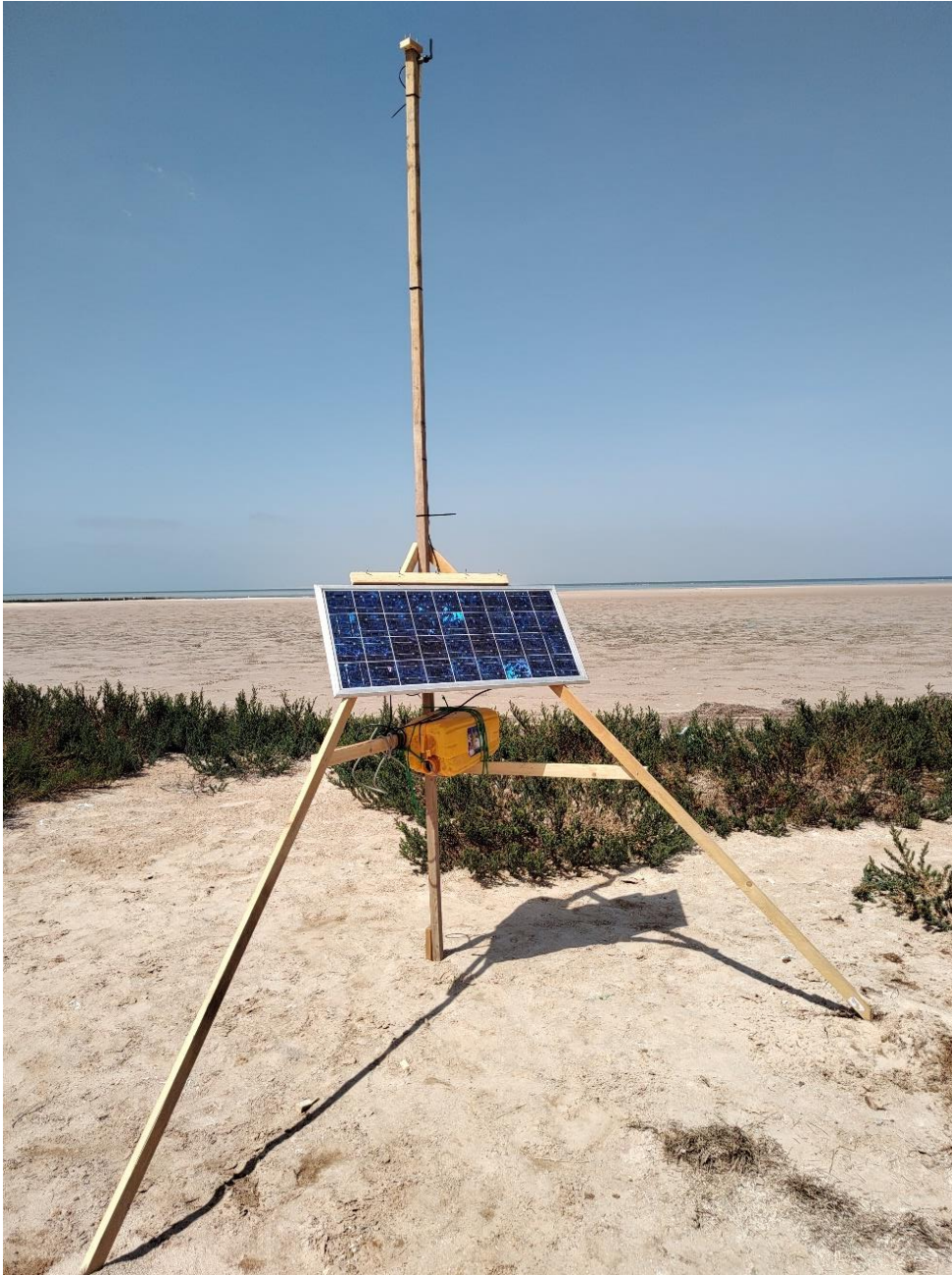
Figure 6. La station de réception de Milsar en Gibene. Photo par Jan van Gils.
